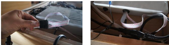
Stecken Sie den Verbindungsstecker an die Innenseite des Steuerungsgeräts in den geeigneten Steckanschluss.
