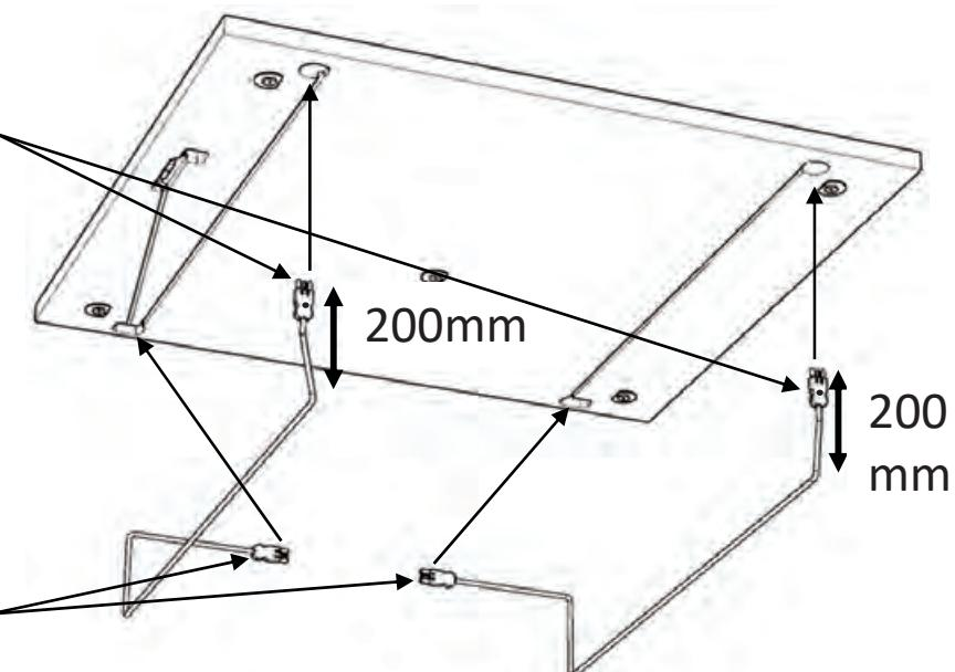
Frontstrahlerkabel einsetzen beidseitig.
