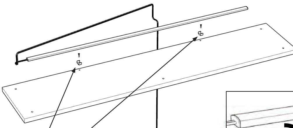
Den dünneren der beiden LED Streifen mit Clips befestigen.
